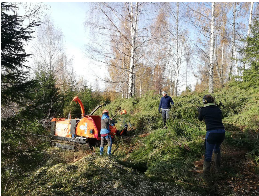
Figur 6 Det ble brukt en flishugger til å findele granene (Foto: A. Rishatt 2021)
