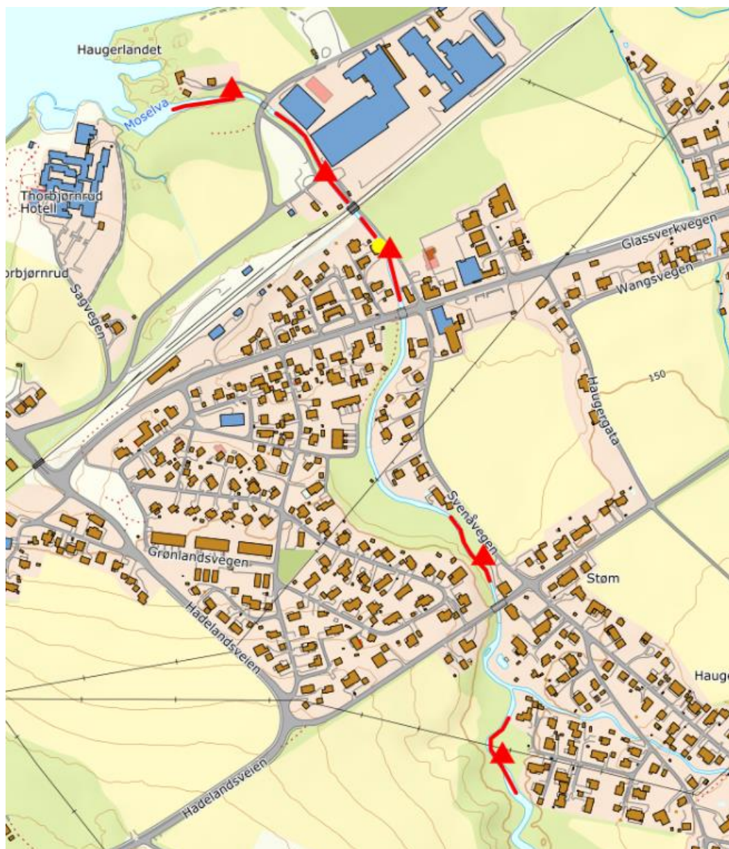
Figur 1. Forslag til strekninger for utlegg av stein i Svenåa/Moselva. Røde streker markerer elvestrekninger som bør vurderes, røde trekanter markerer mulig adkomst til elva og gul prikk markerer forekomst av parkslirekne. Det er svært viktig å unngå videre spredning av parkslirekne og en bør derfor ikke grave eller flytte masser her.
