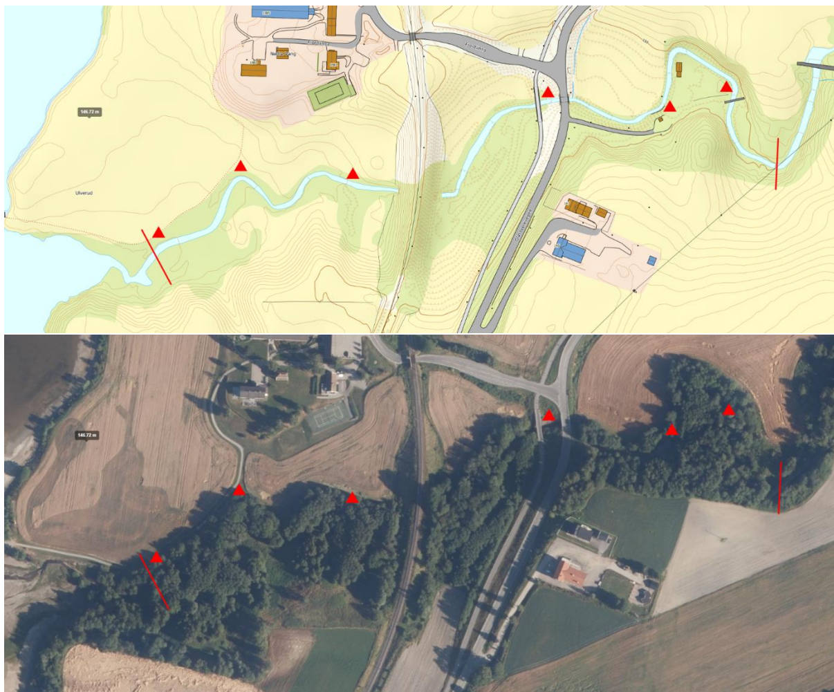
Figur 1. Tiltaksområde for spyling i Vangselva mellom de to røde streker. Røde trekkanter markerer mulig tilkomst til elva med vannpumpe og brannslanger.
