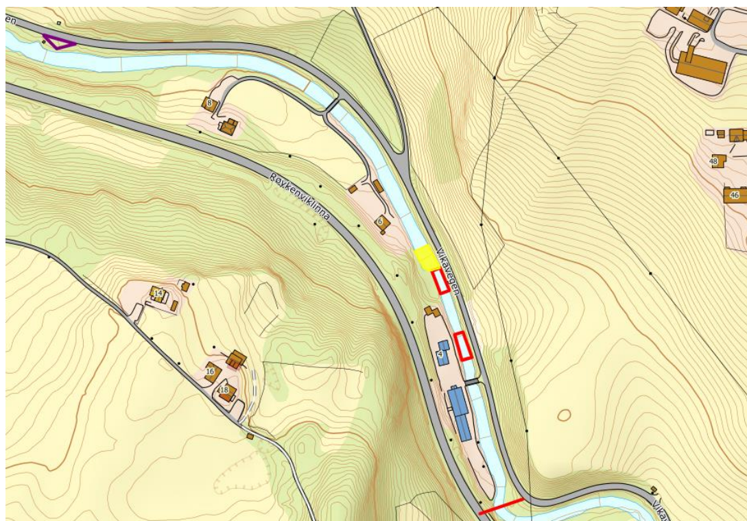
Figur 2. Det gulskraverte området er prioritert for spyling. Området er vanskelig tilgjengelig for ripping, men økt andel hullrom vil være svært gunstig rett nedstrøms utlegging av gyttegrus.
